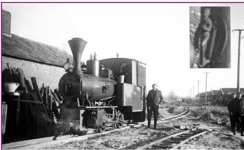
Afbeelding 12. 50 pk spoorlocomotief "het Duiveltje" op het smalspoor bij de steenfabriek Ijsseloord in 1962, de inzet bevat een afbeelding van het beeldje tussen de schoorsteen en de lantaarn dat de naam van de locomotief (bron: www.industriespoor.nl ).
