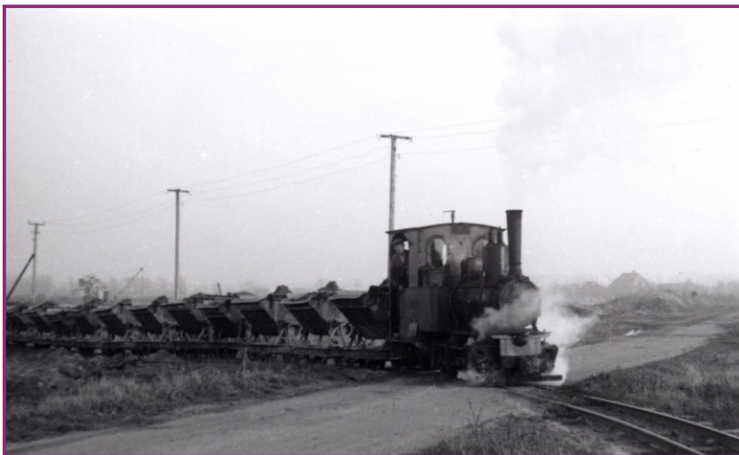
Afbeelding 13: 30 pk Spoortrein "Aagje" met kipkarren op het smalspoor bij de steenfabriek IJsseloord in 1963 (bron: www.industriespoor.nl ).
